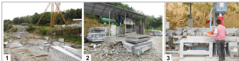
Слика 2 – Површински коп „Бабића рт“. 1. Експлоатација гранитних блокова; 2. Сечење гранитних плоча; 3. Израда коцки од гранита (фото: И. Царевић)
