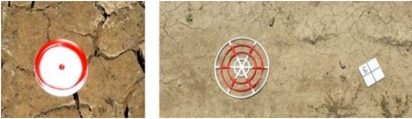
Slika 4. Kontrolni markeri korišćeni u svrhu obezbeđivanja "GCP"
